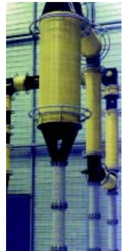
断路器合成试验用电压回路电抗器组
